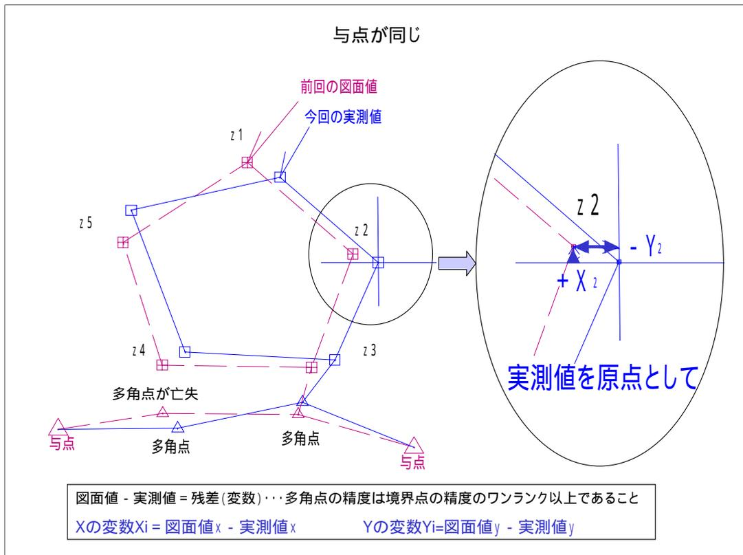
与点があり、多角点が亡失しているときに多角点を新設して測量をし、境界点を測った結果です。
