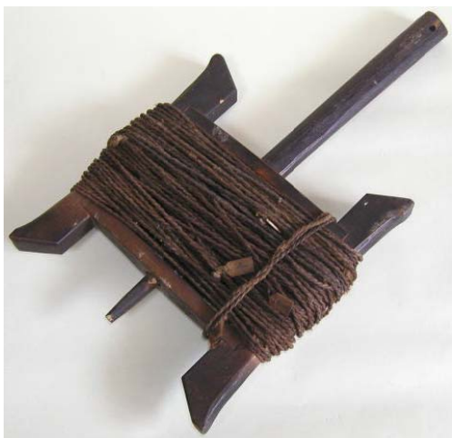
間縄の写真(全長が20間, 約36m, 柿渋を塗って防水処理してある, 1間毎に木札が付けてある)
